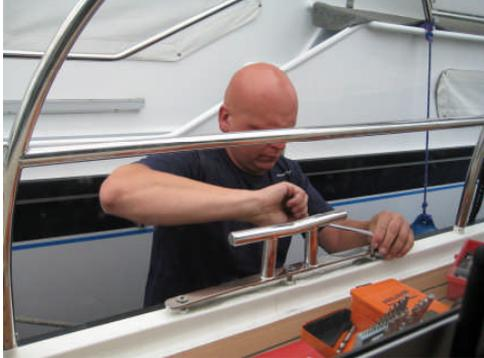
Klampe wieder bringt und montiert. Nach dem Frühstück bringen wir den Schlüssel zurück. Um viertel vor Zehn kommt Dirk mit dem Werkzeug und der geradegebogenen Klampe. Jetzt werden die Löcher etwas aufgebohrt und neue Gewinde geschnitten. Mit etwas größeren Schrauben wird die Klampe befestigt. Das sieht wieder super aus. Wenn man nicht weiß, dass da was kaputt
