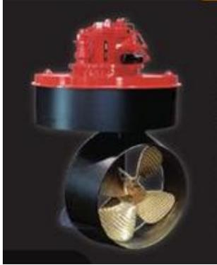
Bugstrahler, 528 PS Scania Motor / 360° drehbar.
